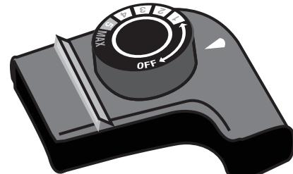
B - Desconecte el enchufe de la toma de corriente. Luego retire el regulador automático de temperatura de la placa calefactora.
